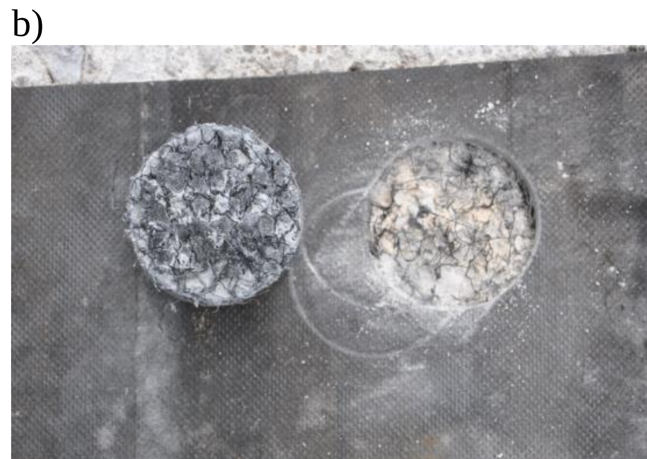
Rys. Próbkki podkładek USP po badaniu – widoczny rodzaj zniszczenia.
