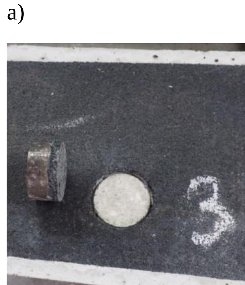
Rys. Próbkki podkładek USP po badaniu – widoczny rodzaj zniszczenia.
