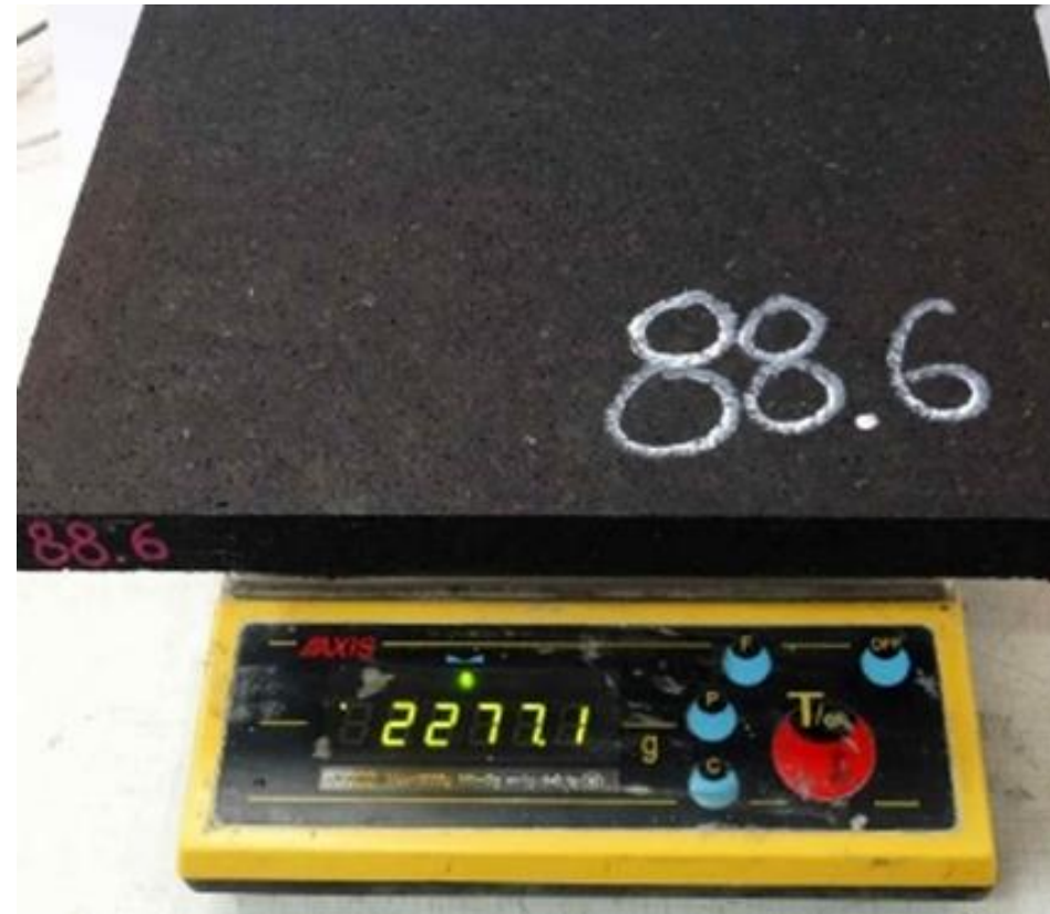
Rys. Próbkę mat UBM w trakcie badań odporności na starzenie: a) próbka w trakcie ważenia; b) komora klimatyczna z badanymi próbkami.
