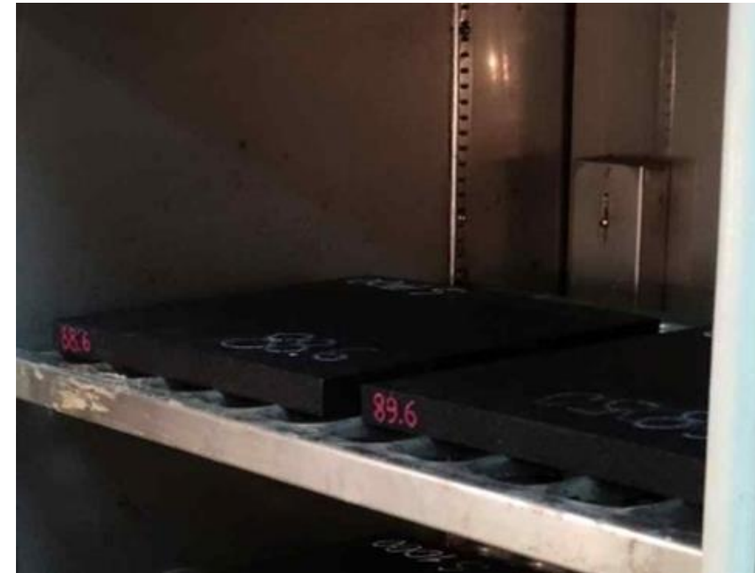
Rys. Próbkę mat UBM w trakcie badań odporności na starzenie: a) próbka w trakcie ważenia; b) komora klimatyczna z badanymi próbkami.
