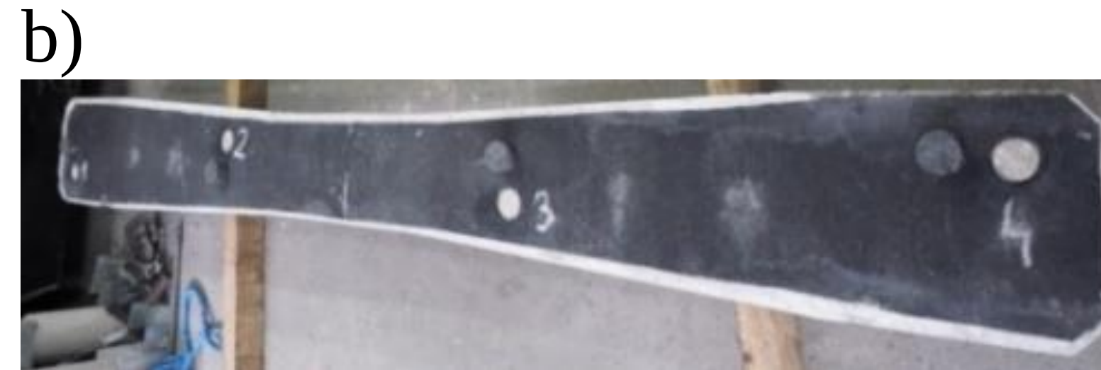
Rys. Podkład z oznaczoną lokalizacją czterech punktów pomiarowych do badania przyczepności przez odrywanie (nr: 1, 2, 3 i 4).
